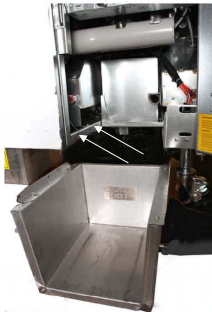
Rysunek 1: Pozycja jednostki topnienia w szafie i dołączyć dostarczonymi śrubami do wnętrza obudowy.
